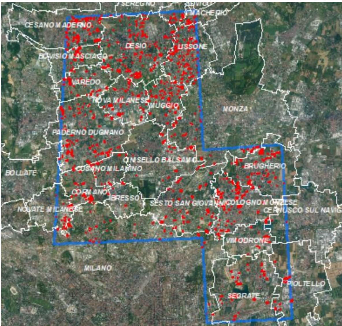
Figura 49. Sintesi, per il poligono di mappatura 2020 “Nord-Est milanese” (poligono blu), della localizzazione dei poligoni con coperture in cemento amianto mappati al suo interno (poligoni rossi), con indicazione dei Comuni mappati (completamente o parzialmente).
