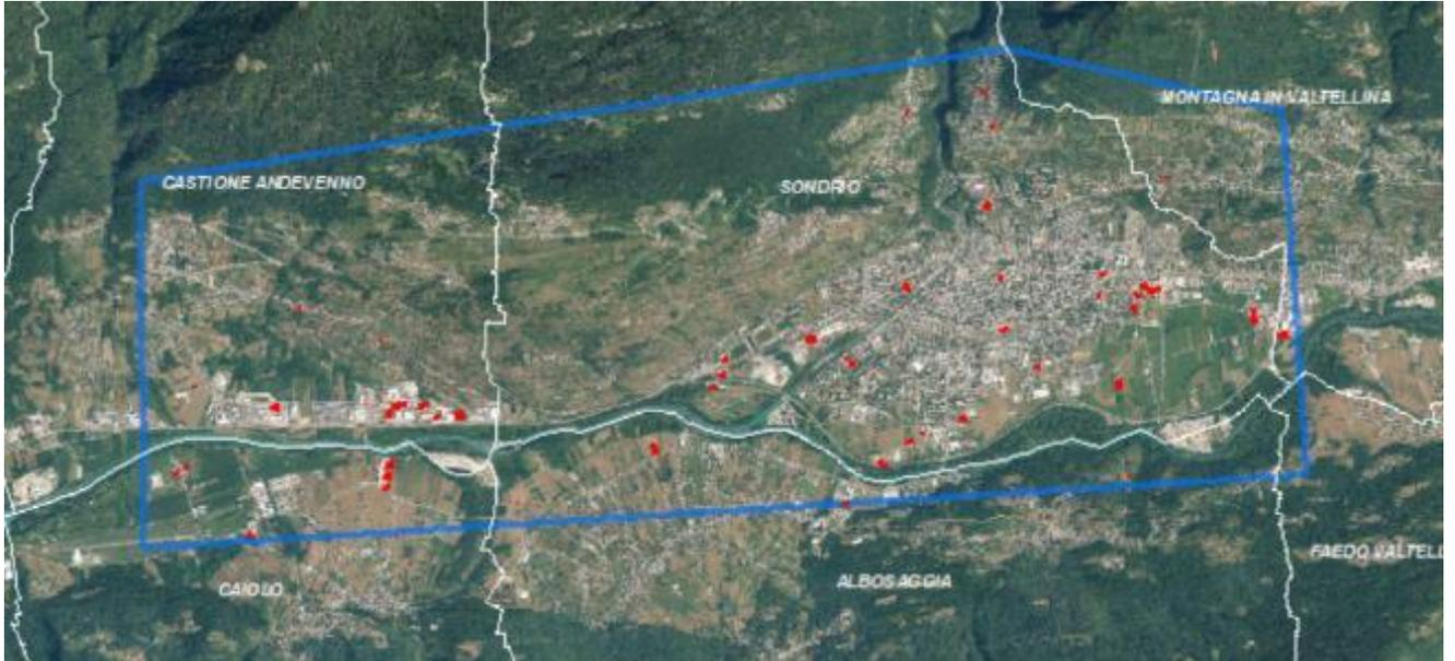
Figura 55. Sintesi, per il poligono di mappatura 2020 "Sondrio" (poligono blu), della localizzazione dei poligoni con coperture in cemento amianto mappati al suo interno (poligoni rossi), con indicazione dei Comuni mappati (completamente o parzialmente).
