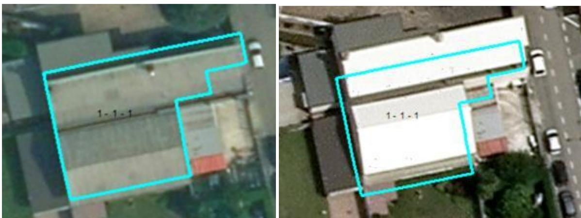
Figura 15. Visualizzazione comparata dell'ortofoto 2015 (sx) e 2018 (dx) per uno specifico poligono oggetto di verifica; la codifica finale 1-1-1 attribuita (ovvero copertura non cambiata nelle tre annualità), è probabilmente errata, poiché è abbastanza evidente un cambio nella copertura visibile nel 2018; la codifica corretta sarebbe in questo caso 1-1-2.
