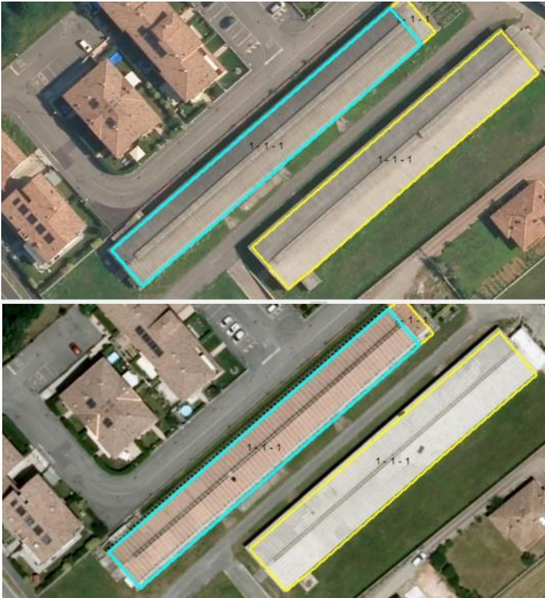
Figura 18. confronto fra ortofoto 2015 (in alto) e ortofoto 2018 (in basso); il poligono azzurro, oggetto di verifica, viene codificato erroneamente come 1-1-1 (ovvero cemento-amianto sempre presente nelle tre date); dal confronto delle ortofoto è invece altamente probabile che sia avvenuto un cambio nella copertura prima dal 2015 al 2018 (ovvero codice corretto 1-1-2).
