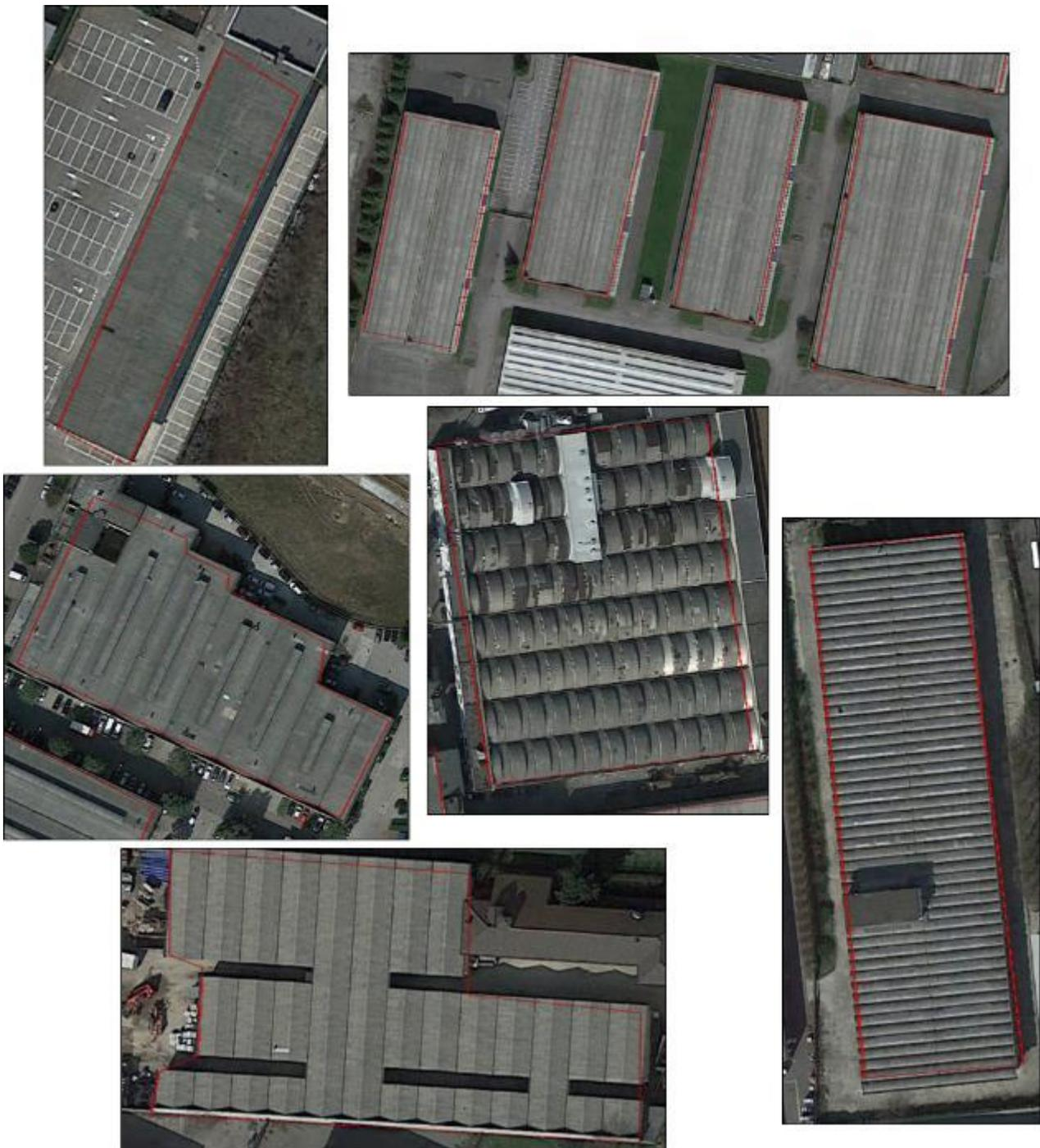
Figura 68: Esempi della variabilità tipica delle coperture in cemento-amianto, visualizzate dai dati aerei ad altissima risoluzione geometrica disponibile in GoogleEarth; i poligoni rossi sono derivanti dalla mappatura precedente realizzata nel PRAL.
