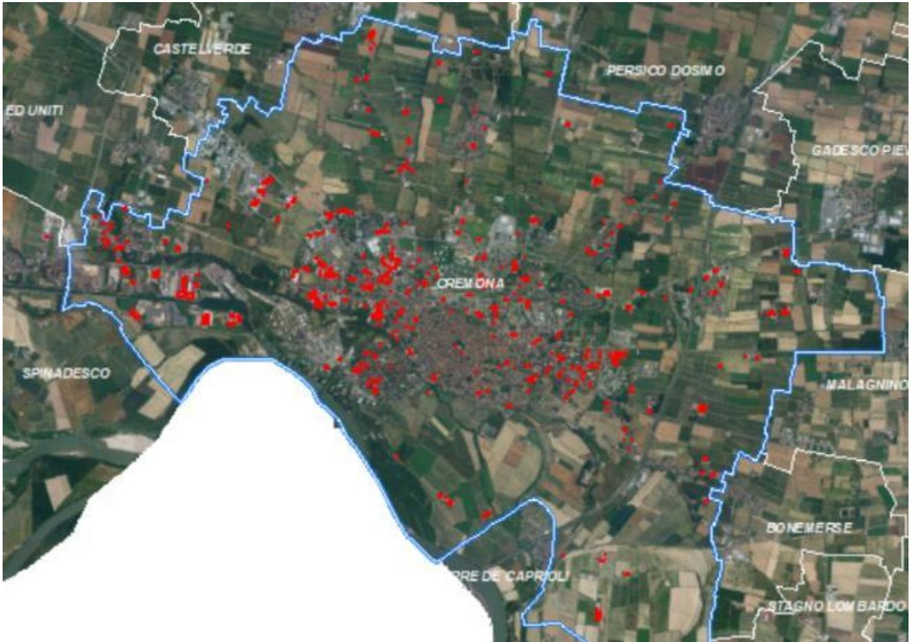
Figura 51. Sintesi, per il poligono di mappatura 2020 "Cremona capoluogo" (poligono blu), della localizzazione dei poligoni con coperture in cemento amianto mappati al suo interno (poligoni rossi).
