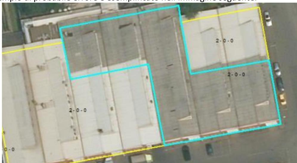
Figura 17. il poligono della mappatura originale in questo caso identificava la totalità della copertura; in fase di aggiornamento e di riporto geometrico è stato diviso in tre diversi poligoni, e per tutte le tre porzioni è stata inserita la codifica 2-0-0 (ovvero cambiamento già osservabile nel 2012); sulla base delle ortofoto è però probabile ritenere che solo in parte la copertura sia stata sostituita; la porzione centrale dovrebbe in questo caso mantenere la codifica 1-1-1.
