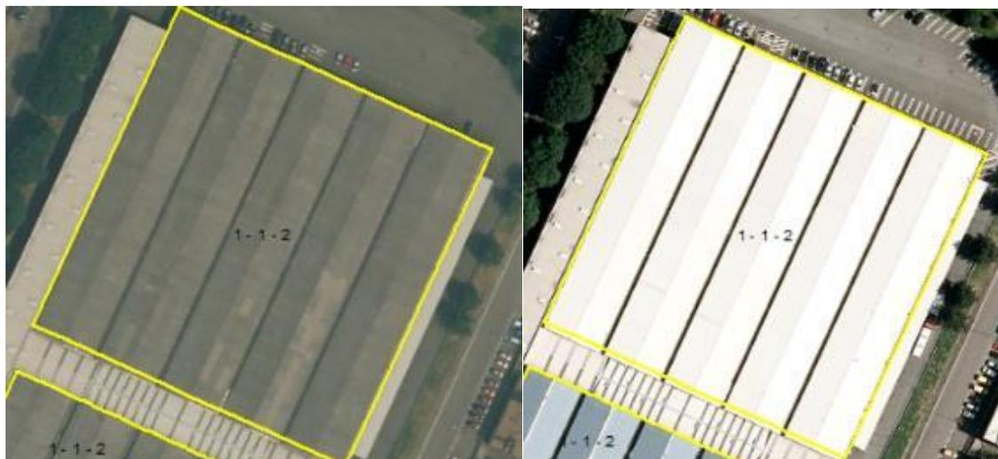
Figura 13. Visualizzazione comparata dell'ortofoto 2015 (sx) e 2018 (dx) per uno specifico poligono oggetto di verifica, per il quale veniva correttamente segnalato un cambio della copertura fra il 2015 e il 2018 (codice 1-1-2).
