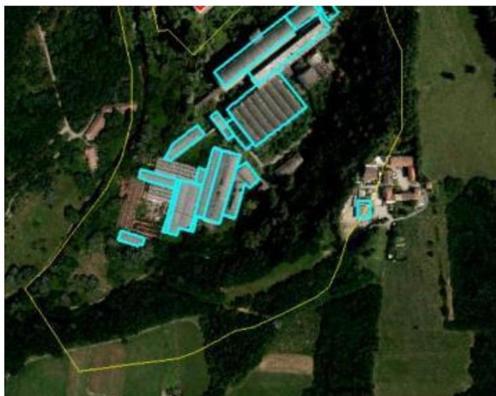
Figura 38. Esempio dell'analisi di confronto fra mappatura delle coperture in cemento amianto all'interno dei poligoni delle aree dismesse; l'esempio è riferito all'area dismessa "ex-cartiera Vita Mayer – Cairate (VA)" (poligono giallo), in cui le coperture risultano ancora in posto nel 2018.
