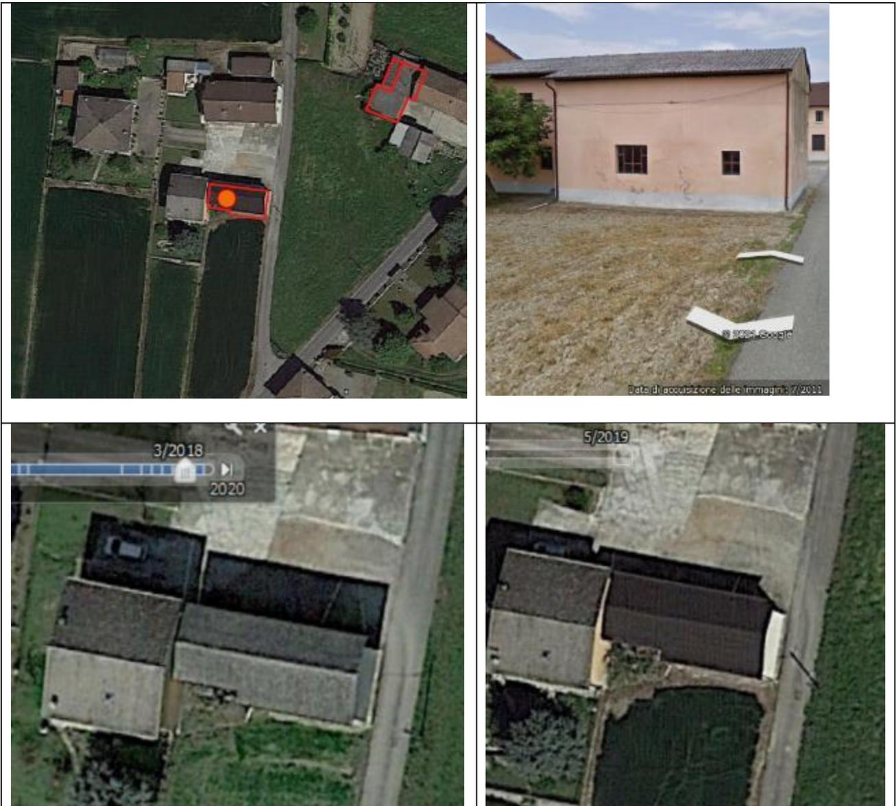
Figura 32. Dettaglio di esempio di un falso positivo: si tratta di una copertura classificata come cemento-amianto, di cui si ha una ragionevole certezza, da immagini aeree e da terra precedenti, che la copertura in cemento-amianto fosse effettivamente in posto almeno fino al 2018, ma appare rimossa poi nel 2019, ed assente quindi alla data del rilievo iperspettrale del 2020.
